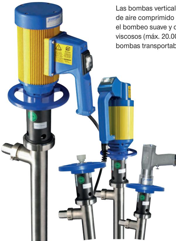
Las bombas verticales de tornillo excéntrico con motores de corriente alterna o de aire comprimido (también disponibles en versión ATEX) son adecuadas para el bombeo suave y de baja pulsación de líquidos de baja viscosidad a líquidos viscosos (máx. 20.000 mPas) desde bidones y contenedores. Se utilizan como bombas transportables o estacionarias en funcionamiento de corta duración.
