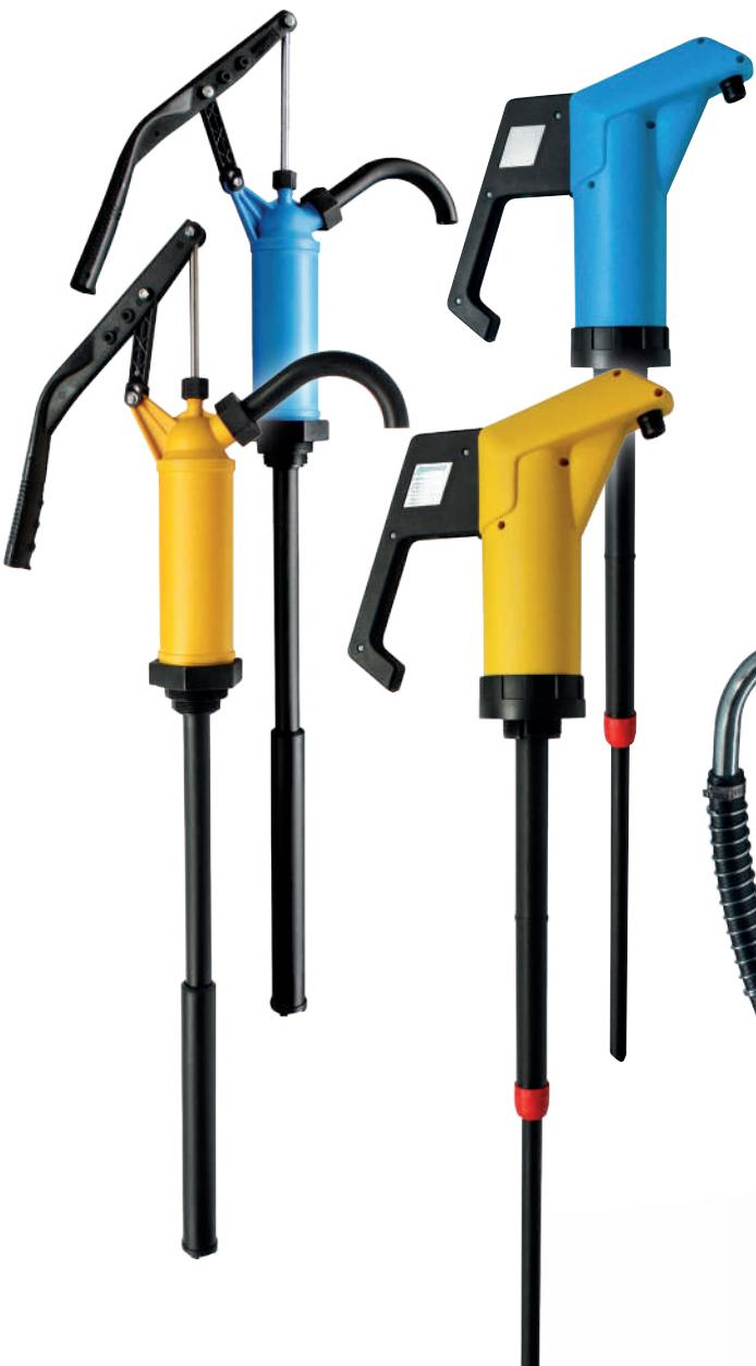
Las bombas manuales son dispositivos ligeros y manejables para el vaciado fácil y seguro de fluidos finos hasta medios de viscosidad media (máx. 1.000 mPas) en pequeños bidones o contenedores de 60 y 200 litros o IBCs.
